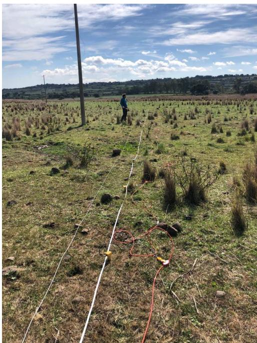
Foto Stendimento di sismica a rifrazione Rz5.
