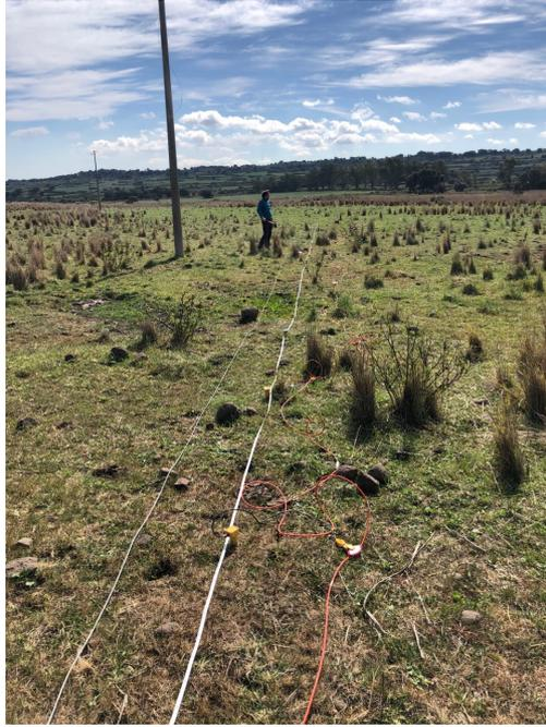
Foto Stendimento di sismica a rifrazione Mw5.
