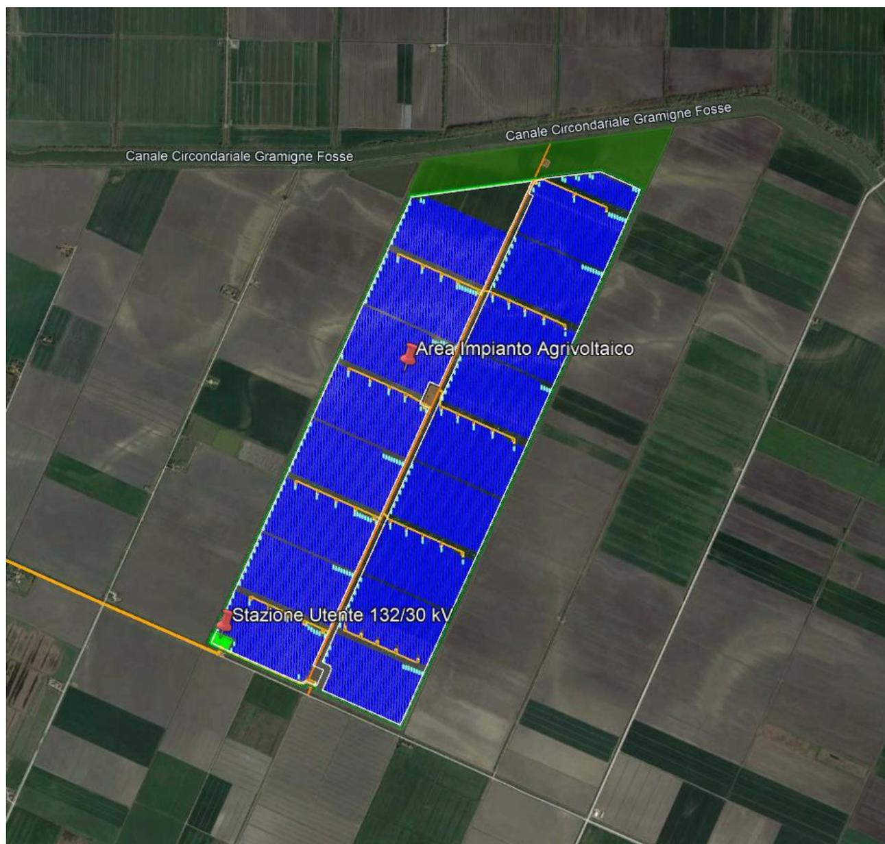
**Figura 3-2: Identificazione del sito di progetto. In colore verde è rappresentata la Stazione Utente di progetto mentre con una linea arancione viene rappresentata la dorsale a 132 kV di progetto.**
