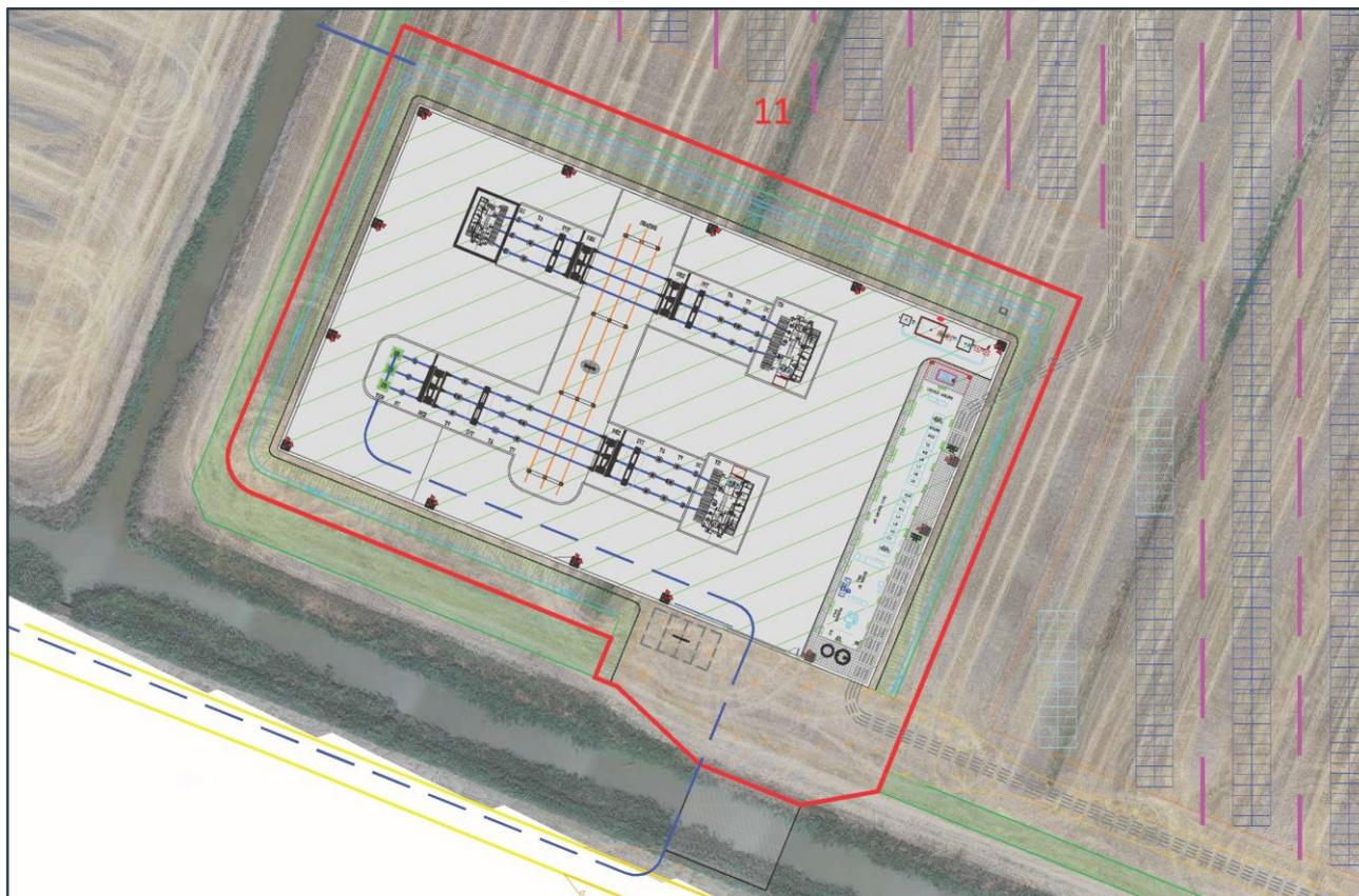
**Figura 6-1: Inquadramento planimetrico dell'area destinata a trasformazione urbanistica, a Sud dell'Area 11, con indicate in grigio le superfici della Stazione Utente, in giallo la nuova viabilità di accesso collegata con Via Val Gramigna.**
