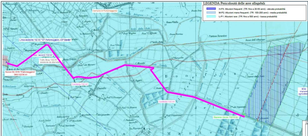
**Figura 4-1. Inquadramento generale su IGM – aree PGRA derivanti dal reticolo principale con indicati in blu l'impianto agrivoltaico di progetto e la Stazione Utente e con una linea di colore magenta il cavidotto a 132 kV di progetto.**
