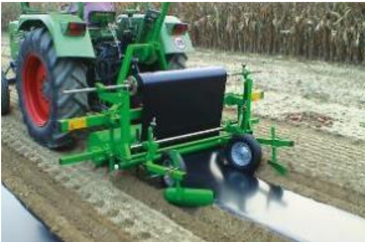
Figura 5.22- macchina utilizzata per la stesura dei film
