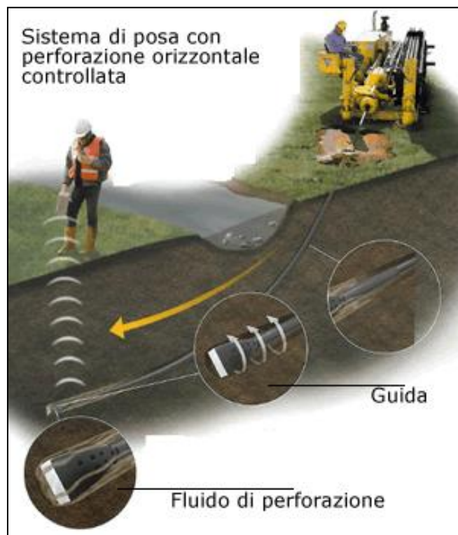
Figura 4-1 - Macchina perforatrice (fonte web)
