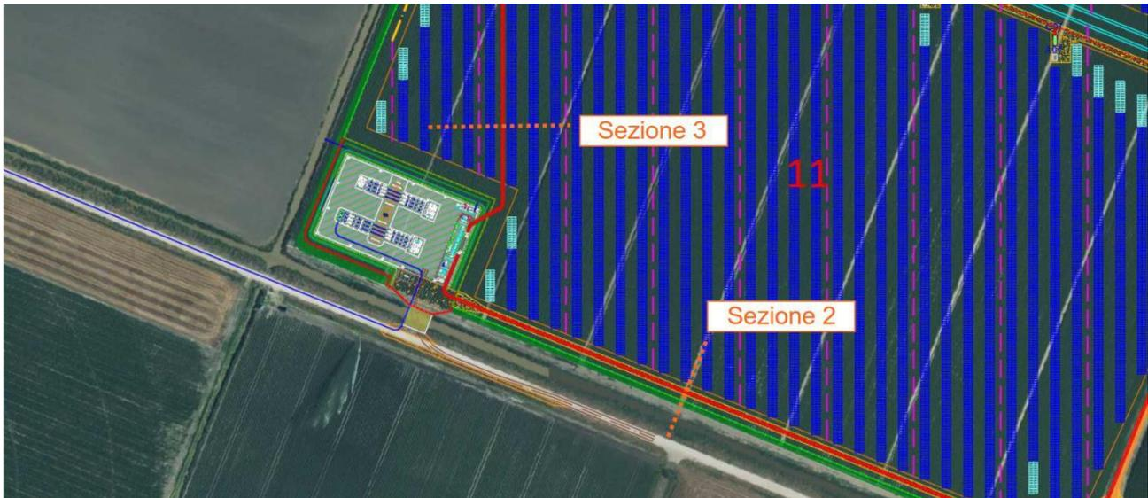
Figura 91: Dettaglio Sezione 2 e 3: Linee 30 kV dal Campo Agrivoltaico alla Stazione Utente
