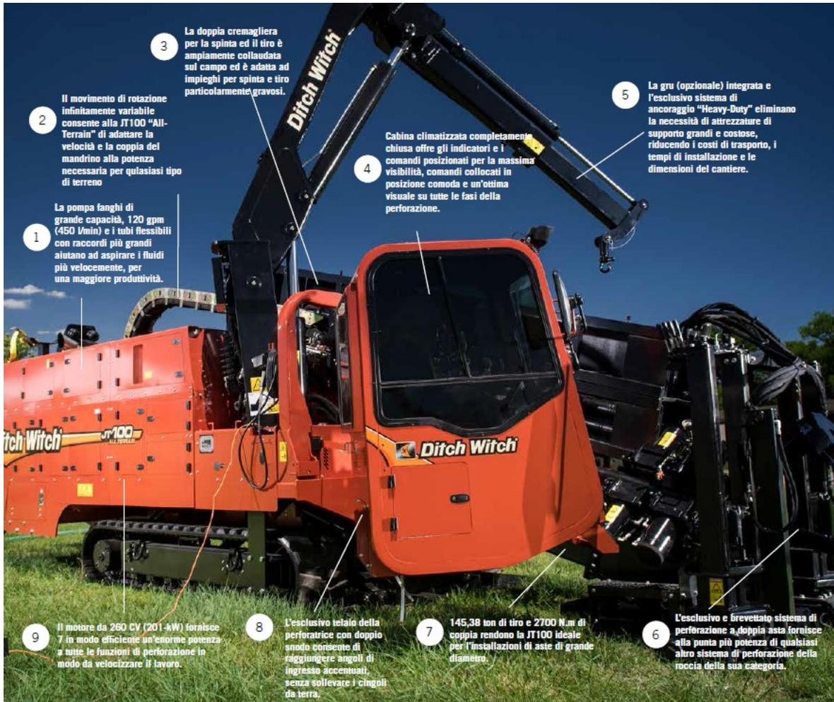
**Figura 5** – Rappresentazione di una macchina perforatrice orizzontale
