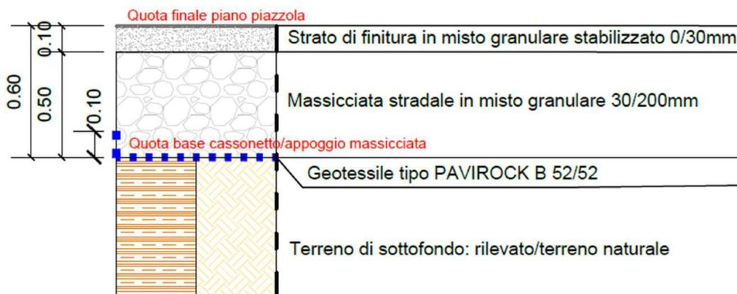
**Figura 1 – Particolare pacchetto di massiccata previsto sulle piazzole di montaggio e stoccaggio**
