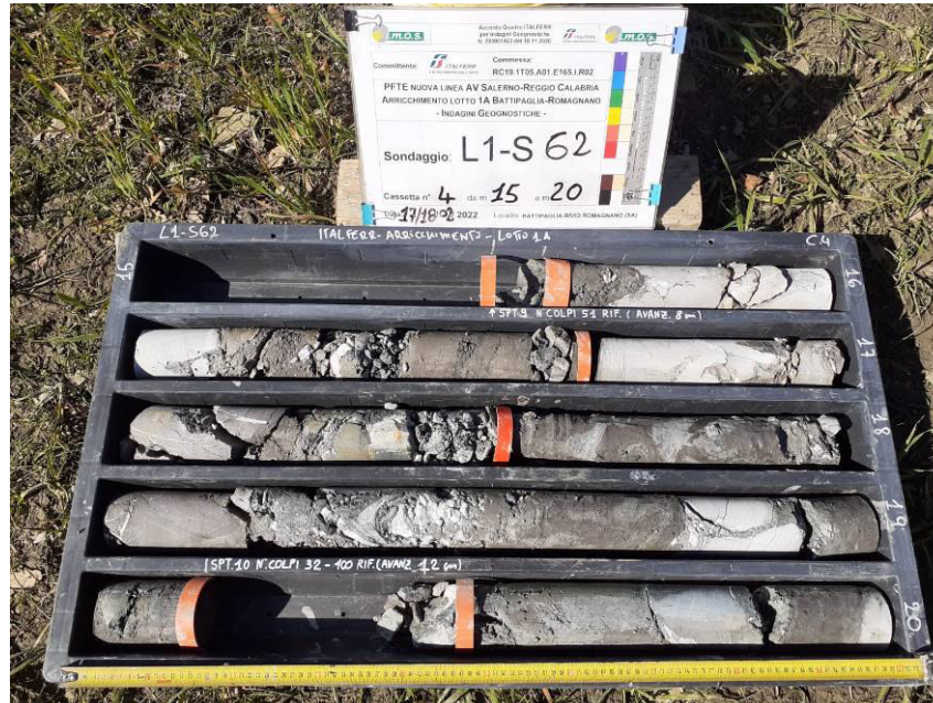
Figura 6 – Esempio di deformazione fragile diffusa, all'interno dei litotipi della Formazione di Monte Sant'Arcangelo in prossimità del contatto con le sottostanti Argille Varicolori Inferiori
