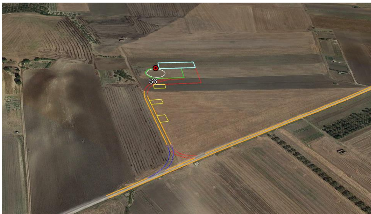
Figura 4.27 – Percorso esistente e di nuova realizzazione di accesso alla postazione eolica S6 (vista verso ovest)
