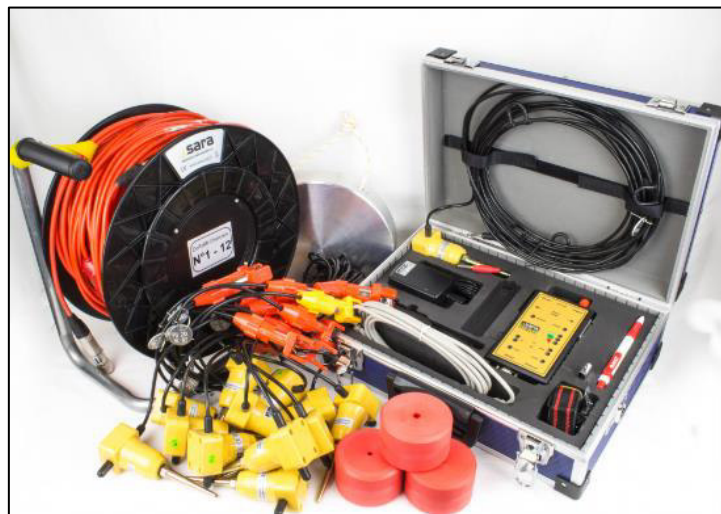
Fig. 1: sismografo DoReMi e Cavo di registrazione.
