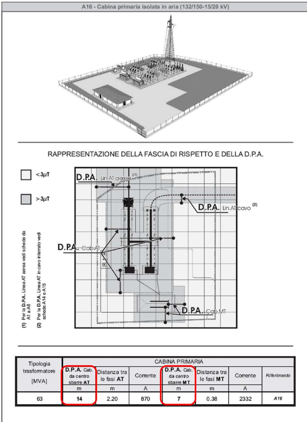
Figura 9: Estratto della guida di Enel sul calcolo della DPA: sottostazioni di trasformazione in AT
