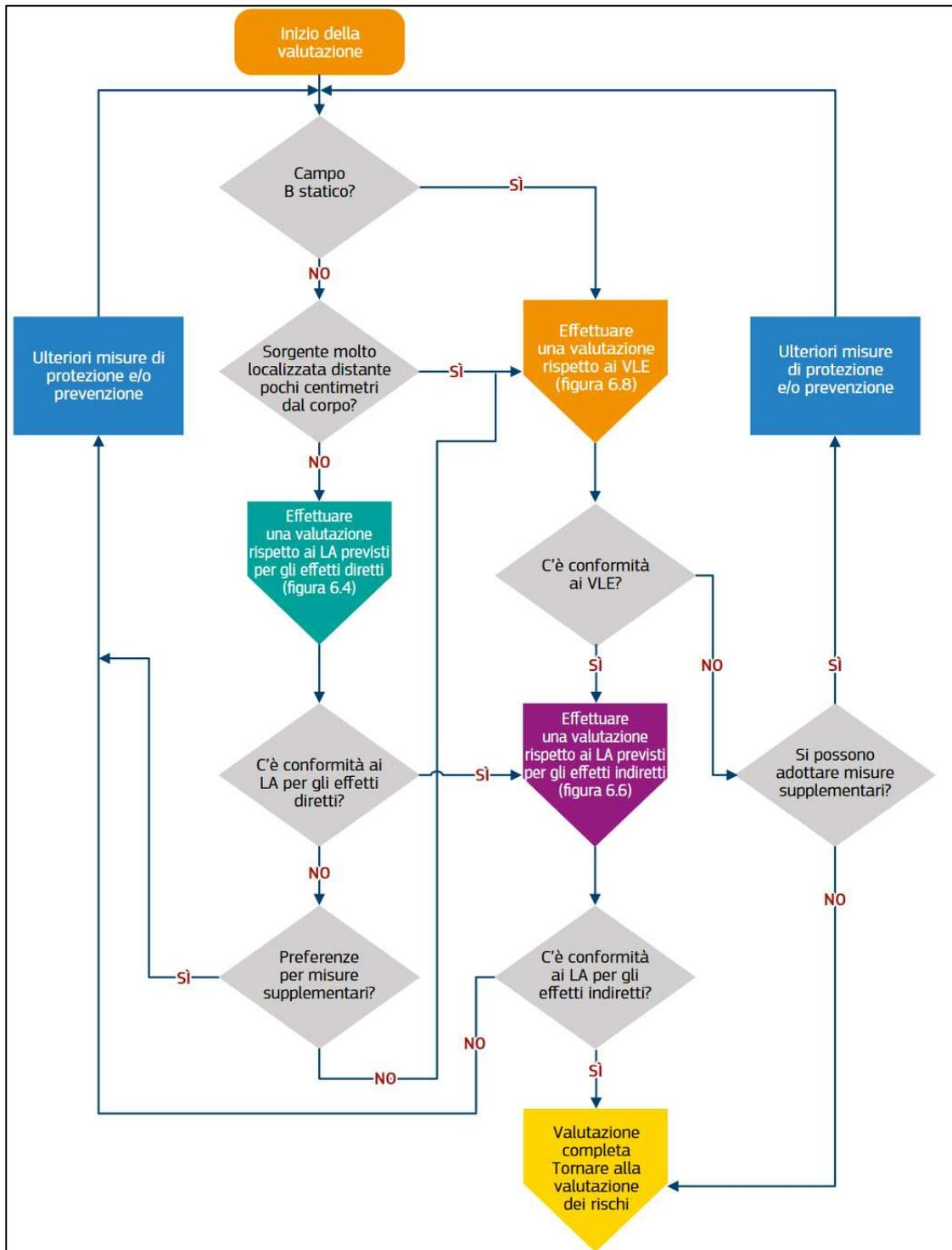
Figura 11: Processo per stabilire se occorre valutare la conformità ai LA oppure ai VLE
