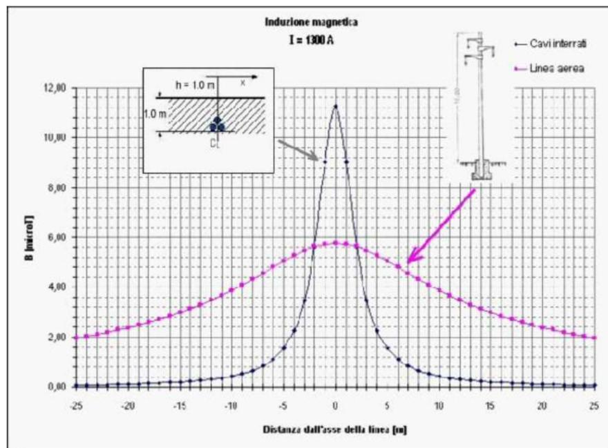
Figura 5: Attenuazione dell'induzione magnetica dovuta all'interramento dei cavi
