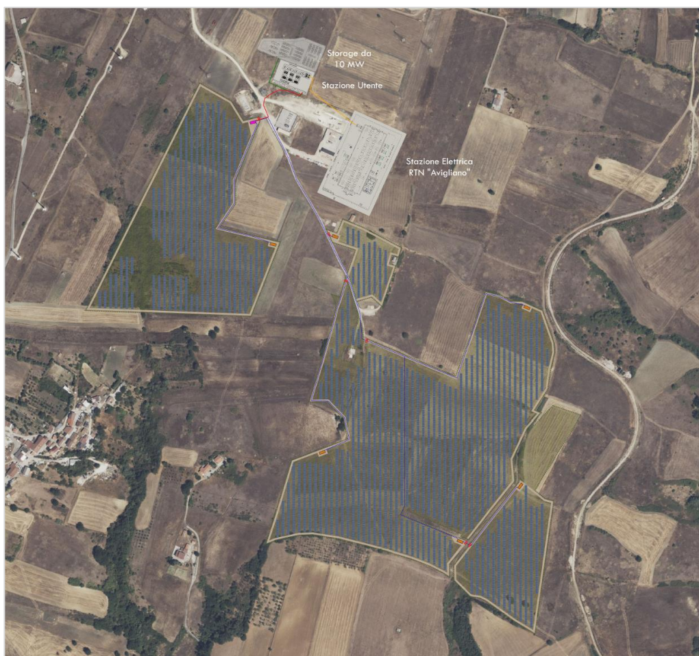
Figura 7. Inquadramento dell’impianto fotovoltaico da 20 MW “POTENZA02” su base Ortofoto.
