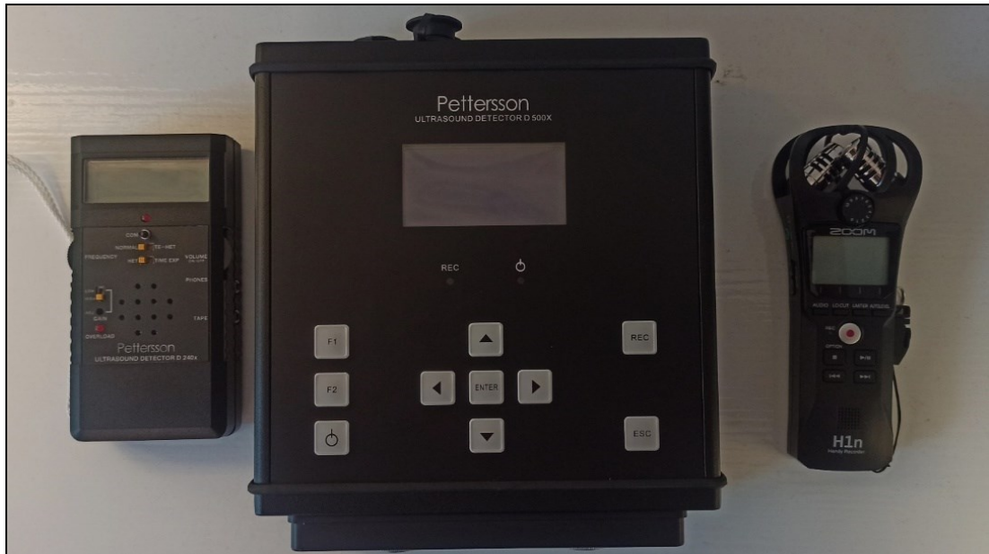
Figura 2: Attrezzatura utilizzata per il monitoraggio dei chiroteri. Da destra verso sinistra: Rilevatore a eterodina ed espansione temporale (x10 e x20 selezionabile). Bat detector D 500X per la registrazione prolungata in campo degli ultrasuoni. Registratore multitraccia collegato al D 240X.
