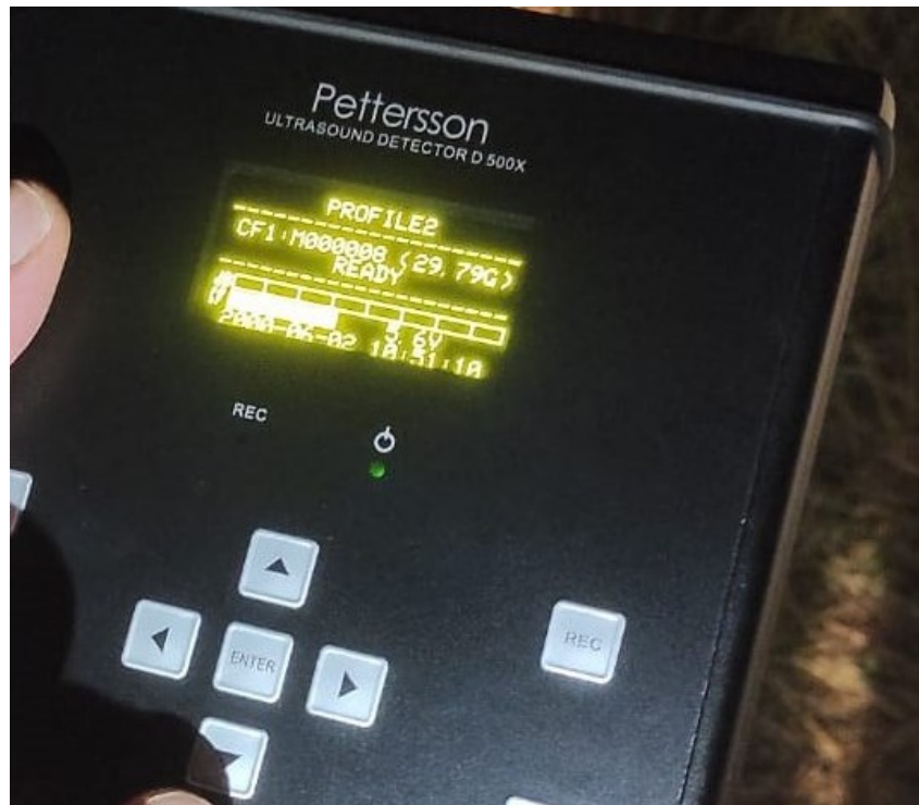
Figura 3: Preparazione del Bat Detector Petterson D500 x per i rilievi su postazione fissa prolungata. Il D500X è un'unità di registrazione a ultrasuoni destinata alla registrazione a lungo termine e incustodita delle chiamate dei pipistrelli. Contrariamente ai rilevatori di pipistrelli a espansione di tempo, il D500X registra gli ultrasuoni a spettro completo in tempo reale praticamente senza interruzioni tra le registrazioni. Il registratore è dotato di quattro slot per schede CF, che in genere consentono di lasciare l'unità sul campo per più di un mese. Il sistema di attivazione consente al dispositivo di avviare automaticamente la registrazione quando viene rilevato un suono.
