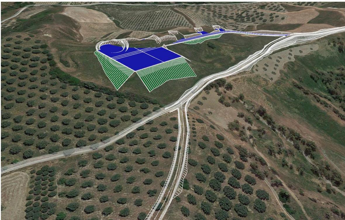
Piazzola SC05: Tale piazzola, con quota di imposta media pari a circa 480,50 metri s.l.m., avrà una superficie di circa 3.100 mq, comprensiva dell'area occupata dalla fondazione che sarà ridotta, in fase di esercizio, a 1.100 mq circa, prevedendosi il rinverdimento per tutta la rimanente parte.
