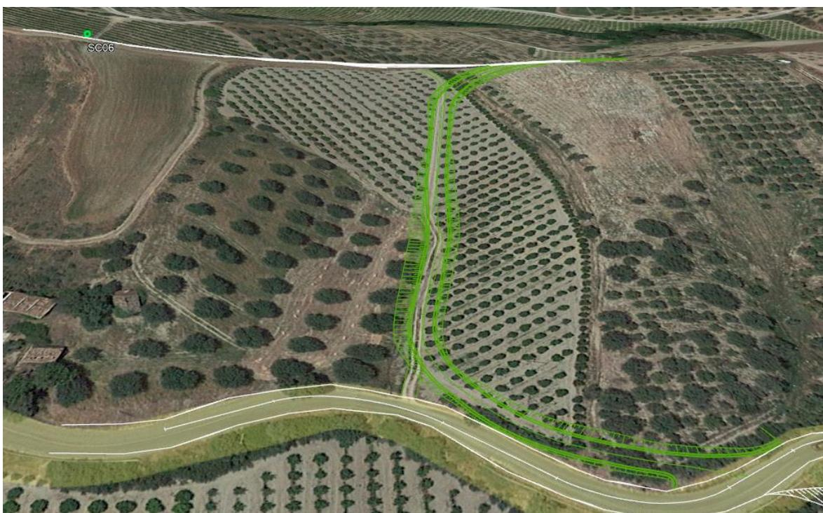
**Asse 08 e Asse 09:** Raggiunta la piazzola dell'aerogeneratore SC06, il convoglio proseguirà sempre in cresta percorrendo l'Asse 08 che verrà percorso in retromarcia.
