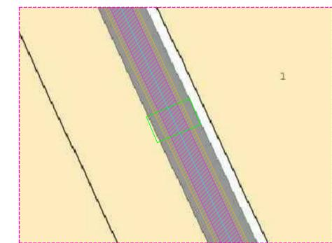
Particolare tracciato elettrodotti con rappresentazione della fascia di asservimento/concessione per posa, esercizio e manutenzione elettrodotti e fascia di rispetto per obiettivo di qualità
