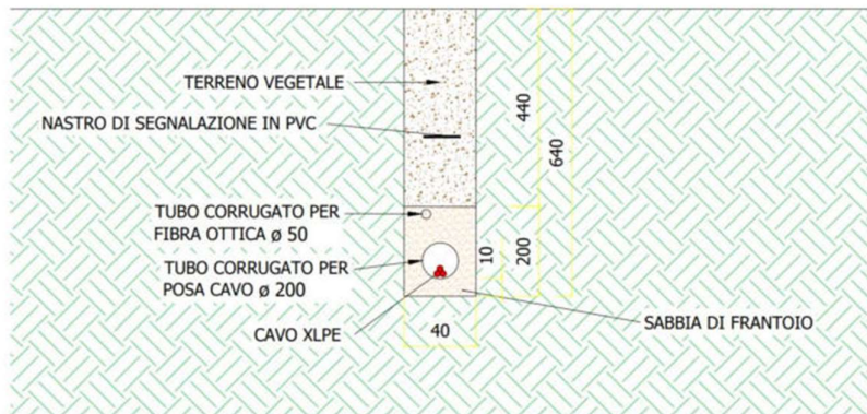
POSA CAVI SU TERRENO AGRICOLO
