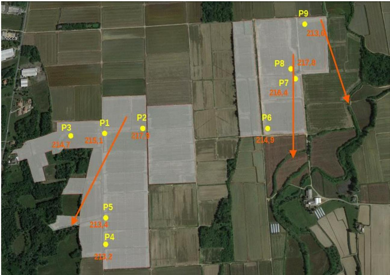
FIGURA 3-5: UBICAZIONE INDAGINI PENETROMETRICHE E QUOTE ASSOLUTE (M S.L.M.) DEL BEDROCK IN ARANCIONE
