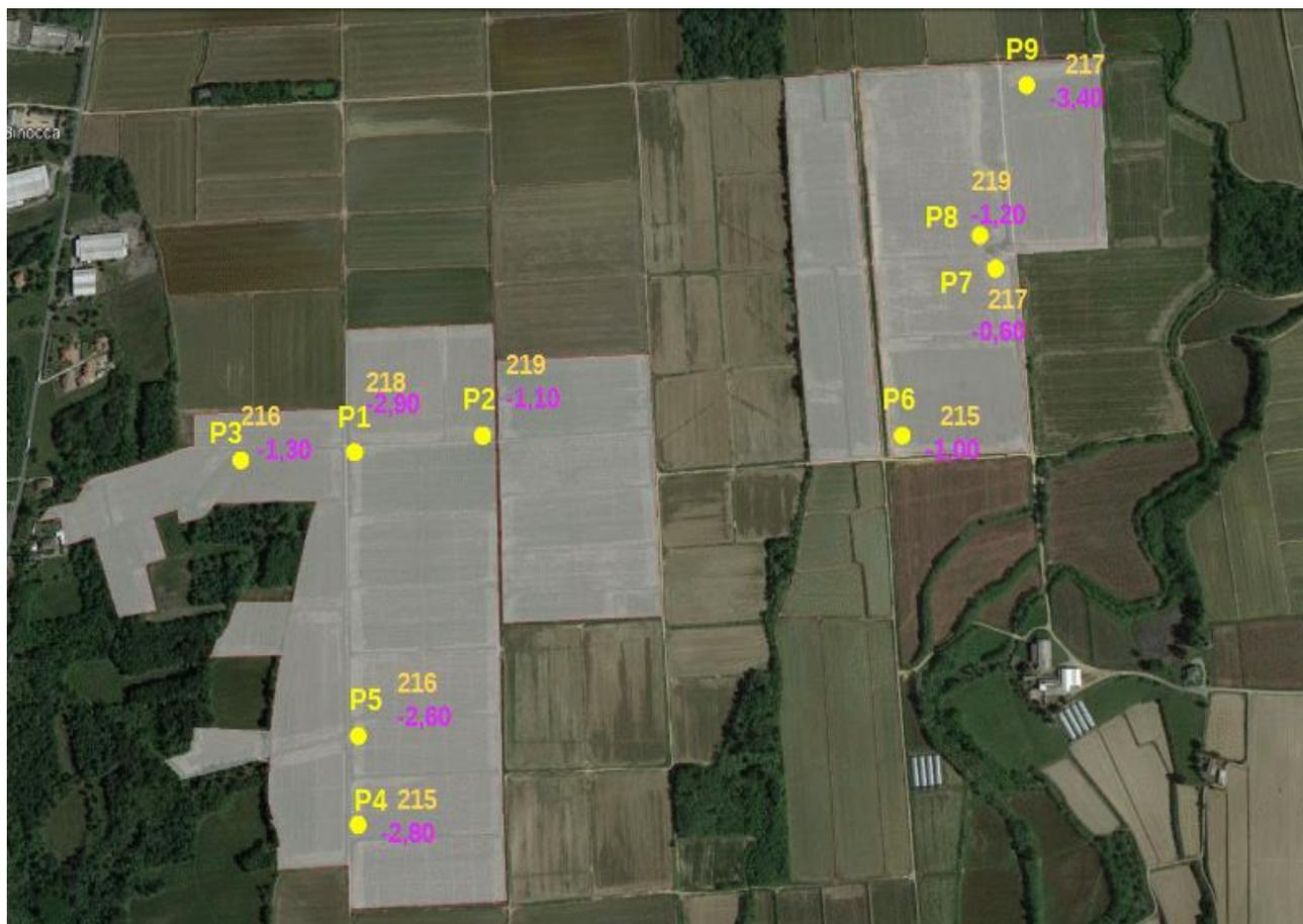
FIGURA 3-4: UBICAZIONE INDAGINI PENETROMETRICHE, QUOTA TOPOGRAFICA (M S.L.M.) IN GIALLO, E QUOTA DI INTERCETTAZIONE DEL BEDROCK A PARTIRE DAL PIANO CAMPAGNA IN VIOLA.
