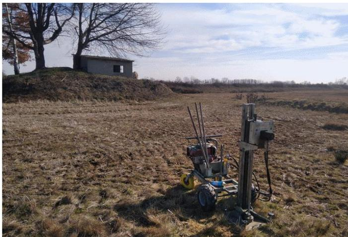
**PROVA PENETROMETRICA DINAMICA CONTINUA**
