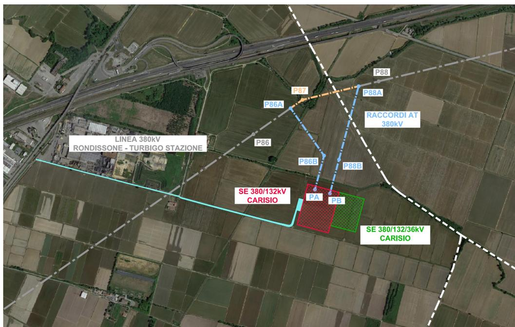
**FIGURA 1-1: INQUADRAMENTO DELLA POSIZIONE DELLA STAZIONE ELETTRICA TERNA SE 380/132 kV RTN CARISIO (IN ROSSO) E L'AMPLIAMENTO DELLA STESSA (IN VERDE)**
