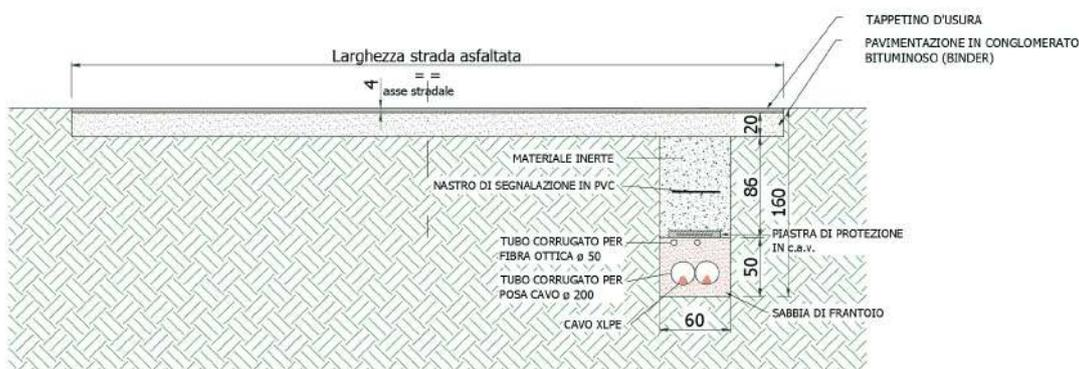
SEZIONE DI POSA TIPICA CAVIDOTTI ALTA TENSIONE SU STRADA IN CONGLOMERATO BITUMINOSO
