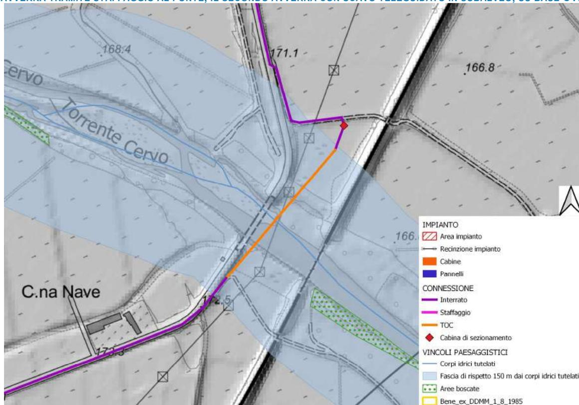
**TRATTO DI CONNESSIONE INTERFERENTE CON LA FASCIA DI RISPETTO DEL T. CERVO. L'ATTRAVERSAMENTO AVVERRÀ TRAMITE SCAVO TELEGUIDATO IN SUBALVEO, INTERVENTO NON SOGGETTO ALL'OTTENIMENTO DI AUTORIZZAZIONE PAESAGGISTICA**
