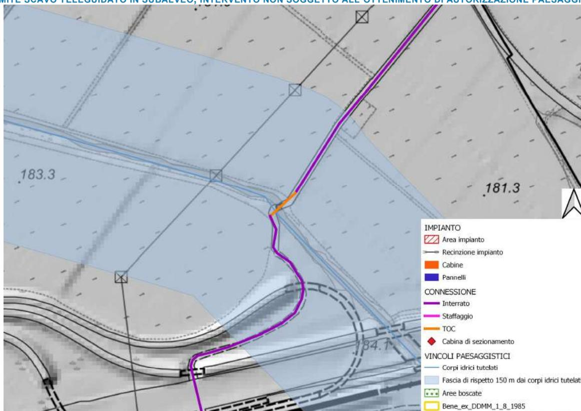
**TRATTO DI CONNESSIONE INTERFERENTE CON LA FASCIA DI RISPETTO DEL T. ODDA. L'ATTRAVERSAMENTO AVVERRÀ TRAMITE SCAVO TELEGUIDATO IN SUBALVEO, INTERVENTO NON SOGGETTO ALL'OTTENIMENTO DI AUTORIZZAZIONE PAESAGGISTICA**
