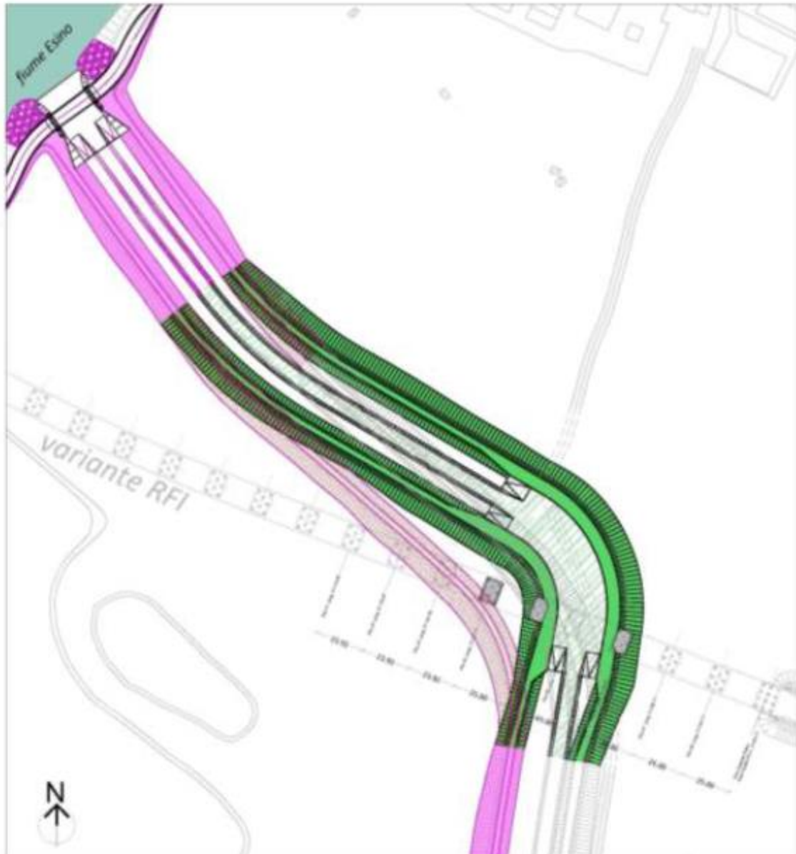
Figura 1: Planimetria individuazione tratto in variante (in verde le parti oggetto della perizia di variante, in magenta gli interventi previsti in progetto esecutivo non oggetto di modifiche in corso d'opera rilevanti)
