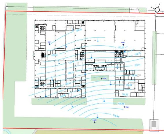
Estratto da SPA-REV01 - figg. 4-45 e 4-46 : andamento piezometrico rilevato all'interno del sito
