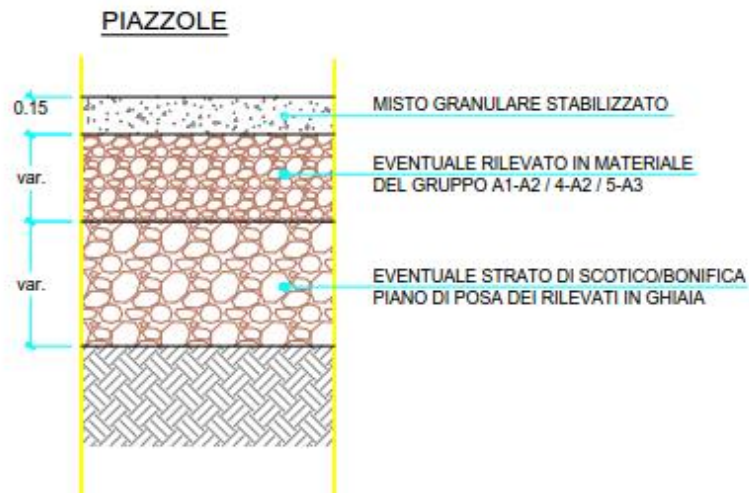
Figura 7.6: sezione tipo delle piazzole
