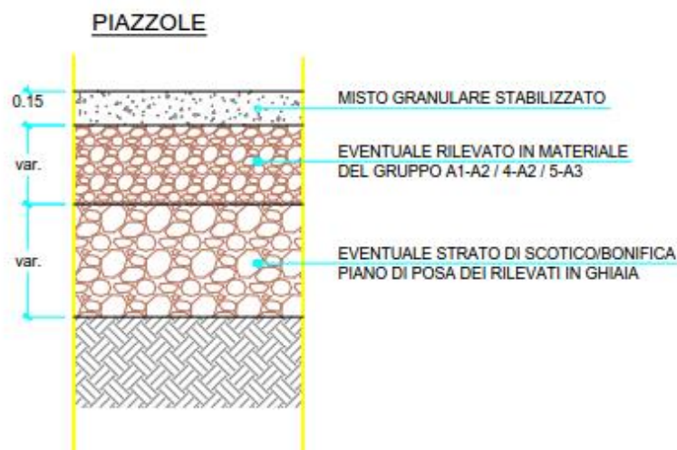
Figura 5.3: sezione tipo delle piazzole
