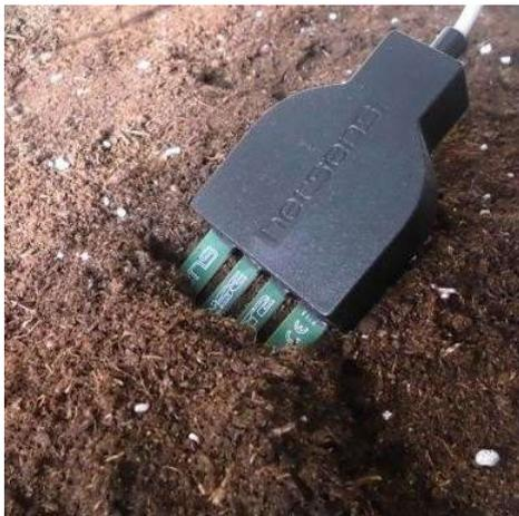
Figura 5: Sensore di umidità
