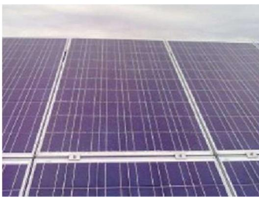
*Figura 20: Modulo con superficie compressa*
