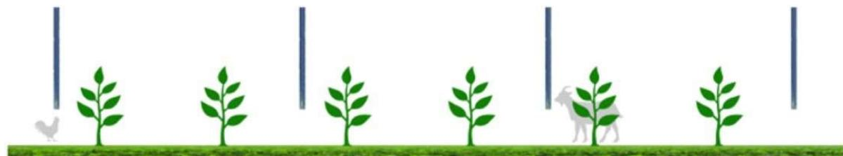
Figura 3: Sistema agrivoltaico in cui i moduli fotovoltaici sono disposti verticalmente. La coltivazione avviene tra le file dei moduli fotovoltaici, l'altezza minima dei moduli da terra influenza il possibile passaggio di animali (TIPO 3)
