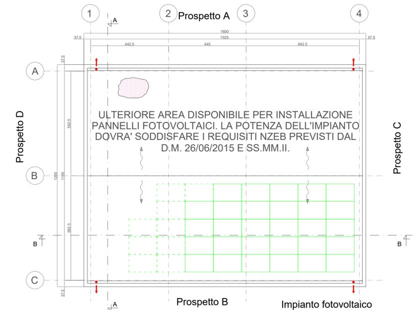
Nota: L'eventuale integrazione con i pannelli fotovoltaici rappresentati con un tratteggio dovrà essere valutata in fase di progettazione esecutiva al fine di massimizzare la producibilità dell'impianto fotovoltaico in relazione a fattori ambientali sito-specifici.
