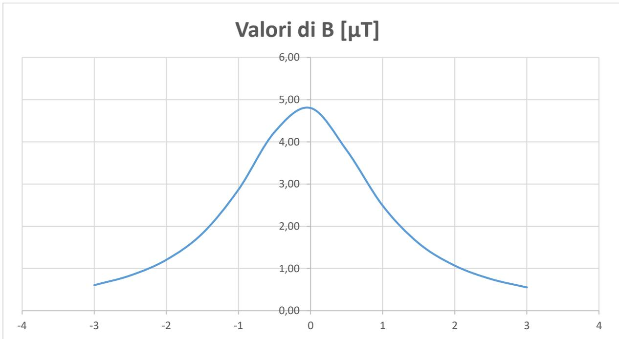
Ricordando che l'obiettivo da rispettare per il caso in esame è l'obiettivo di qualità, pari a 3 µT, si rileva che il cavidotto oggetto di studio produce un campo magnetico massimo, in corrispondenza all'asse centrale sul piano di calpestio, pari a 4,80 µT, superiore all'obiettivo di qualità fissato dalla norma, ma comunque inferiore al limite di esposizione di 100 µT.
