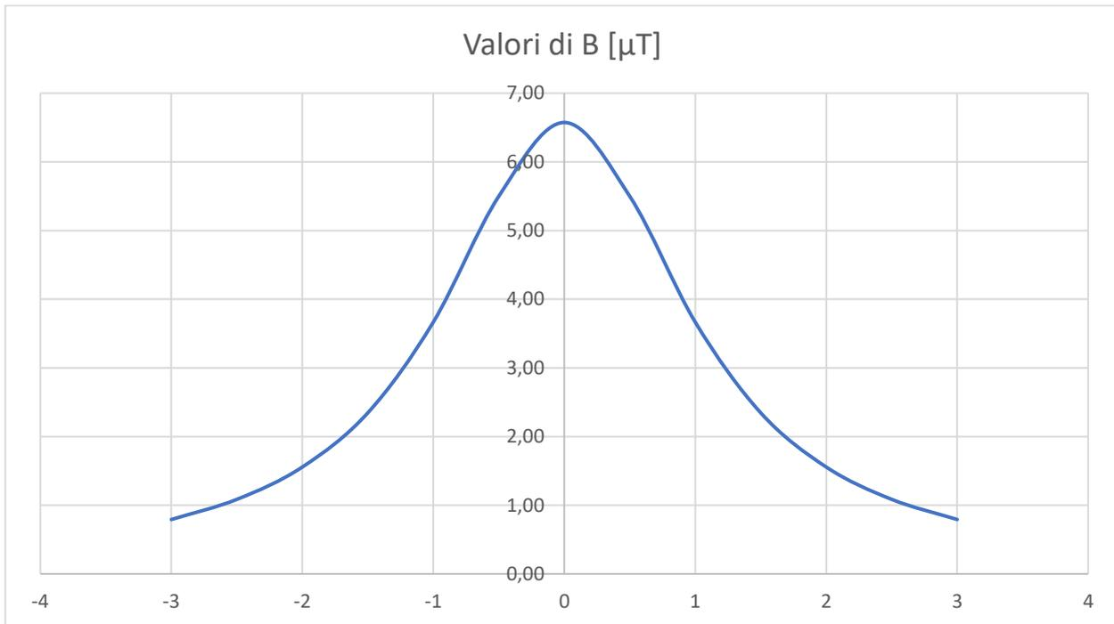
Ricordando che l'obiettivo da rispettare per il caso in esame è l'obiettivo di qualità, pari a 3  $\mu\text{T}$ , si rileva che il cavidotto oggetto di studio produce un campo magnetico massimo, in corrispondenza all'asse centrale sul piano di calpestio, pari a 6,57  $\mu\text{T}$ , superiore all'obiettivo di qualità fissato dalla norma, ma comunque inferiore al limite di esposizione di 100  $\mu\text{T}$ .
