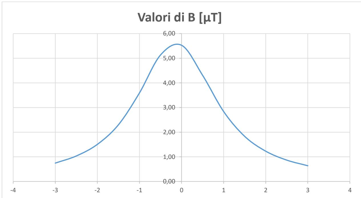
Ricordando che l'obiettivo da rispettare per il caso in esame è l'obiettivo di qualità, pari a 3 µT, si rileva che il cavidotto oggetto di studio produce un campo magnetico massimo, in corrispondenza all'asse centrale sul piano di calpestio, pari a 5,53 µT, superiore all'obiettivo di qualità fissato dalla norma, ma comunque inferiore al limite di esposizione di 100 µT.
