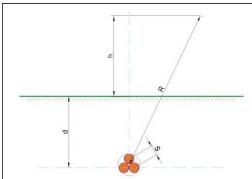
**Figura 1 – Modello di calcolo per 1 terna a trifoglio**
