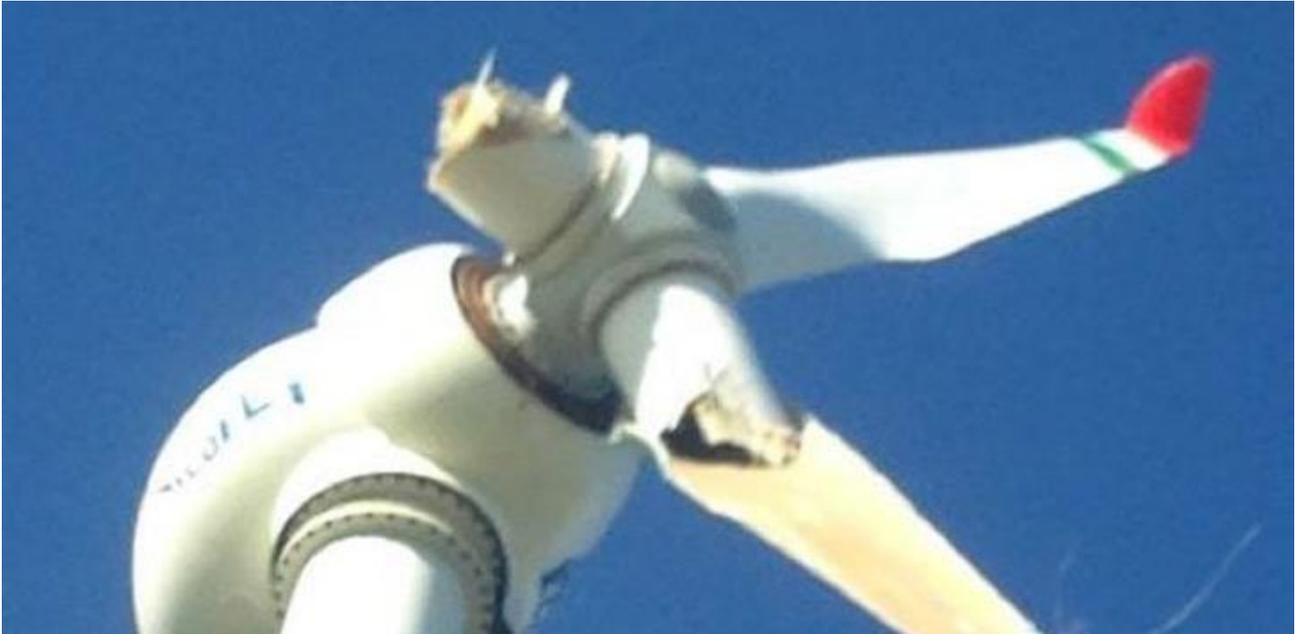
*Figura 5- Esempio di rottura alla radice*
