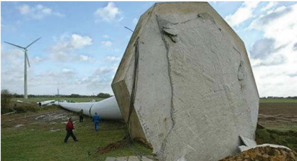
*Figura 8- Ribaltamento della torre e del plinto*
