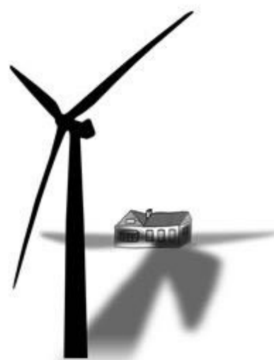
Figura 12 Rappresentazione grafica dell'impatto dell'ombra generata da una turbina eolica
