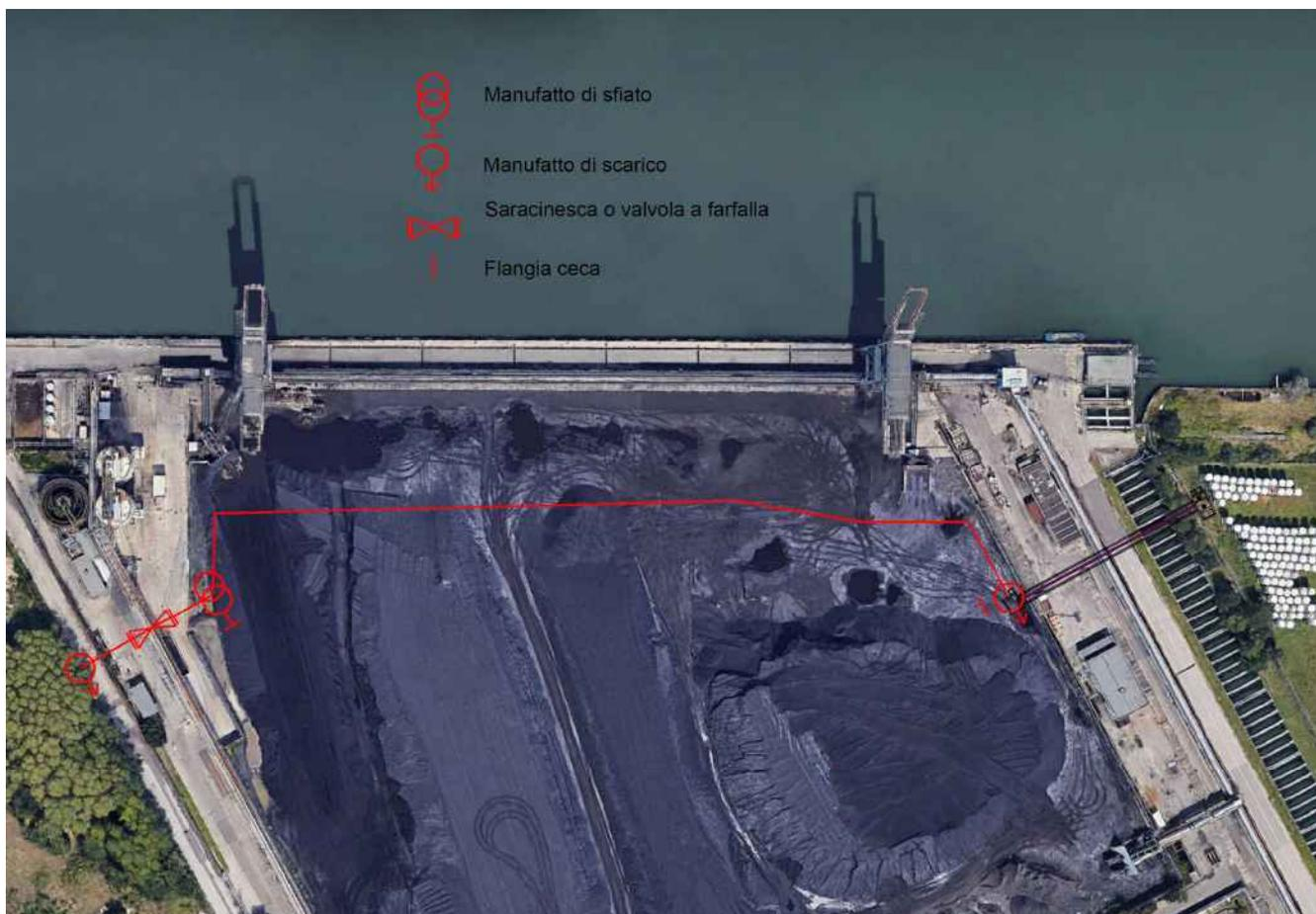
Figura 3-8. Profilo planimetrico della condotta del riuso con gli appositi organi di regolazione ed intercettazione (fonte immagine: Google Satellite).
