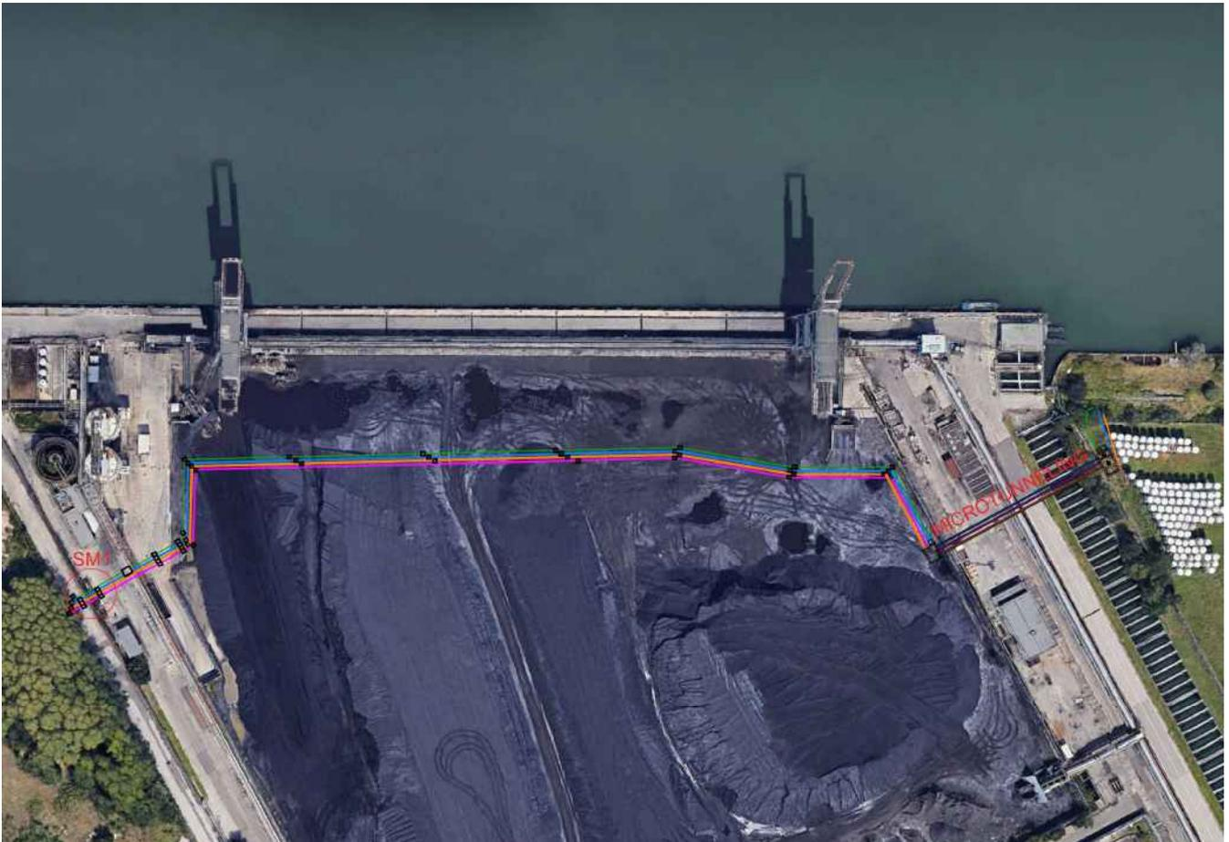
Figura 3-7: Ortofoto della rete idraulica di progetto. Dal lato banchina verso l'esterno, nell'ordine: la linea dreni (in verde), la linea B3 (in blu), la linea B1+B2 (in arancio) e la linea del riuso (in ciclamino). Il cerchio rosso indica l'attraversamento a sifone. (fonte immagine: Google Satellite)
