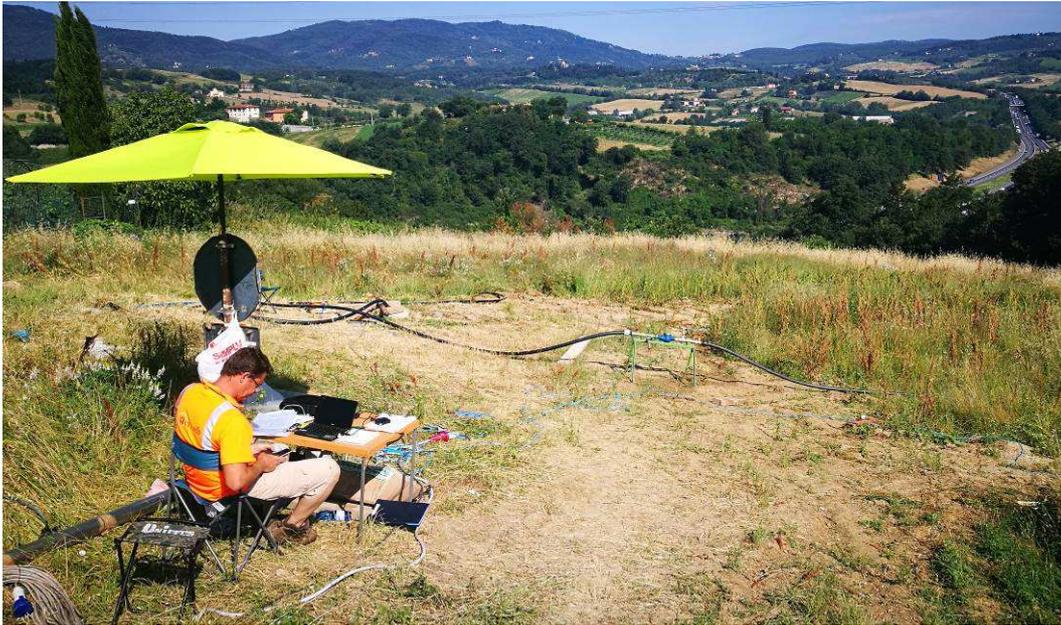
**Figura 33 - Allestimento per la prova di emungimento di lunga durata (72 ore) sul pozzo; sul tubo di mandata è riconoscibile il contatore per il controllo della portata in emungimento.**
