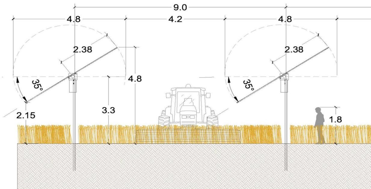
Figura 10 - Sezione dell'impianto agrivoltaico con pannelli tracker.
