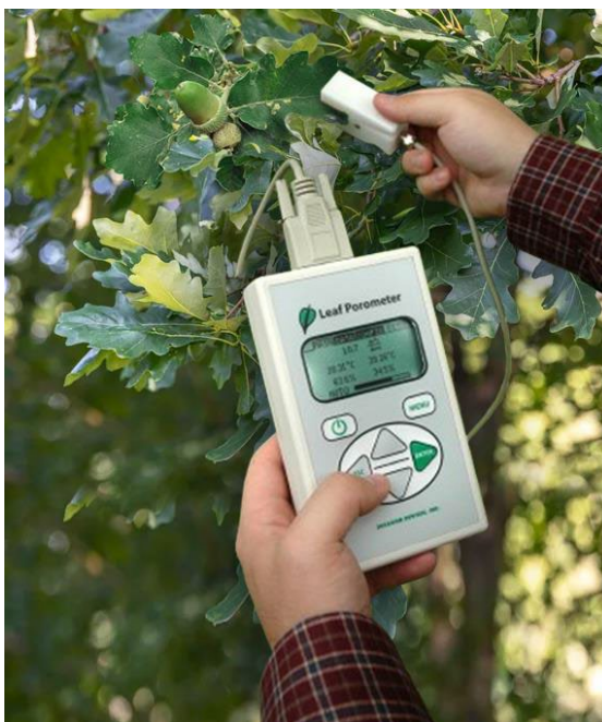
Sensore LEAF-POROMETER dell'impianto di arboricoltura di essenze tartufigene
