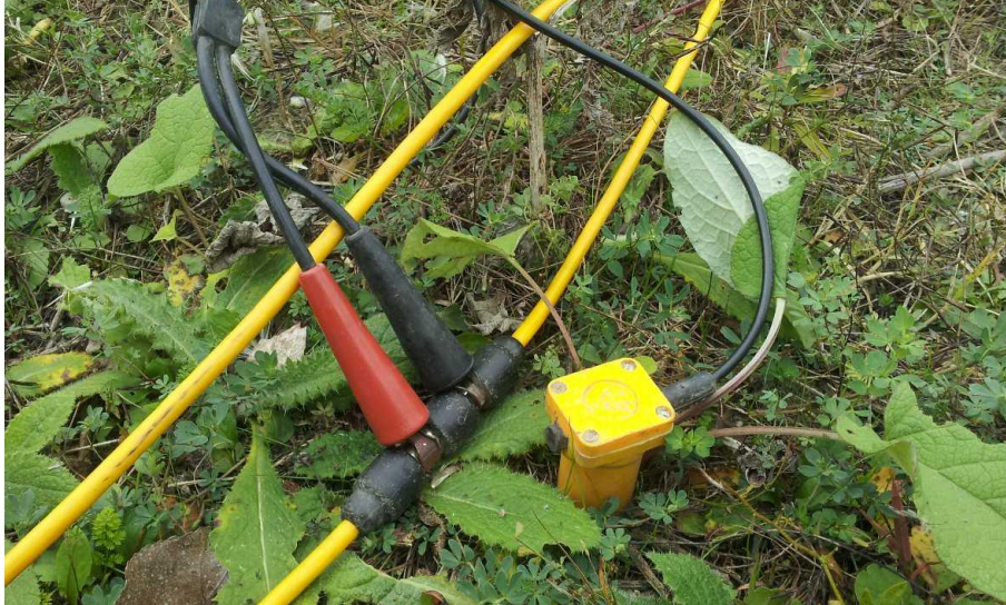
Figura 5 – Geofono verticale SENSOR SM-6/U-B.
