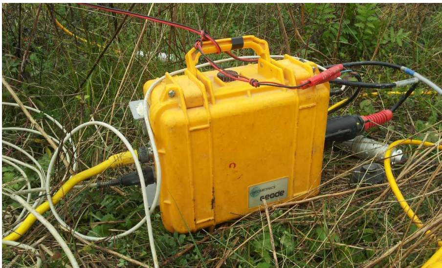
Figura 4 – Sismografo Geometrics Geode.
