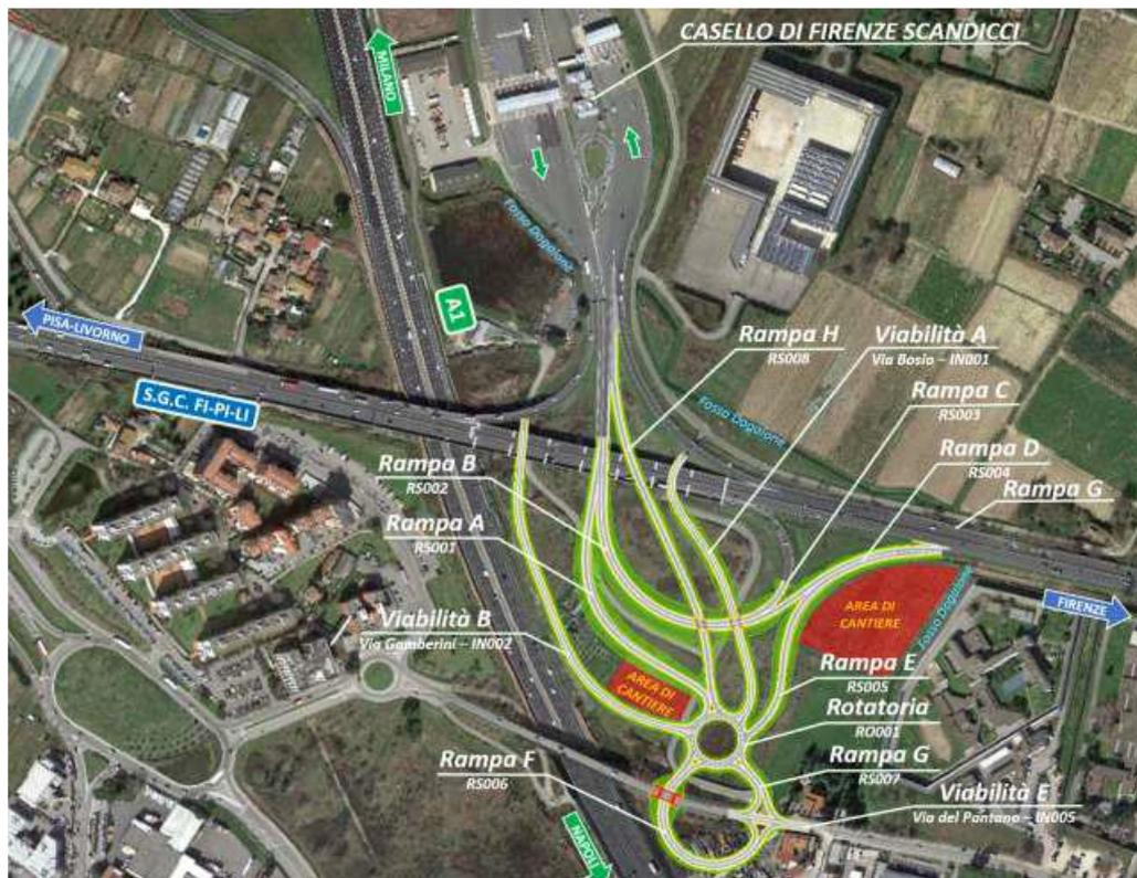
La **Rampa A**, monodirezionale, si stacca dalla rampa bidirezionale ed è utilizzata da chi proviene dal piazzale di esazione per accedere alla rotatoria di progetto. Tale asse sottopassa il viadotto esistente della FI-PI-LI e non necessita di alcuna opera d'arte.
