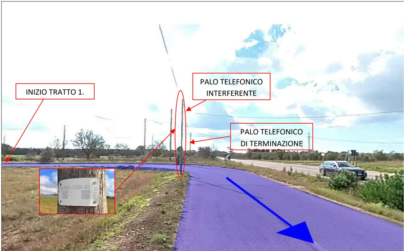
Le linee telefoniche ed elettriche aeree presenti in prossimità della prima curva del tratto 1. hanno una freccia massima rilevata di 6 metri per la linea telefonica e di 8 metri per la linea elettrica MT. In corrispondenza della curva è presente un palo telefonico che costituisce un'interferenza nell'area di transito del convoglio. A tal proposito deve essere previsto uno spostamento temporaneo oppure un interrimento del tratto dal palo precedente al palo successivo di terminazione.
