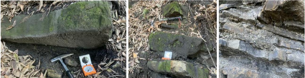
*Figura 2.6: rilievi geologici fatti a gennaio 2024 sul versante della collina di Servola esposto a ovest-sud-ovest lungo il quale è prevista la struttura in pali secanti di sostegno del previsto sbancamento funzionale alla realizzazione del rilevato ferroviario della nuova Stazione di Servola. È confermata la giacitura a reggipoggio e l'alternanza di strati marnosi e arenacei tipici del flysch*
