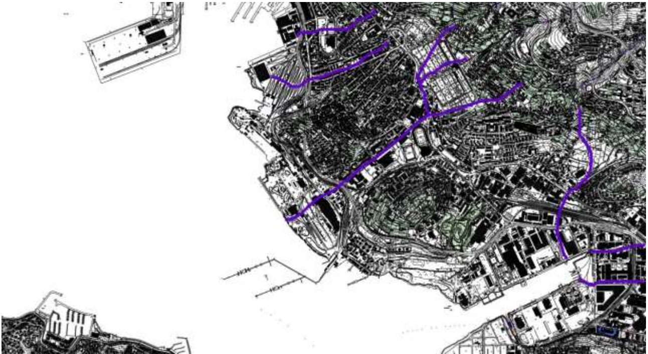
Figura 6-49 – Carta geomorfologica rappresentante i corsi d’acqua superficiali che raggiungono il mare tramite condotta canalizzati. (Fonte: Carta Geomorfologica e dell’Idrografia Superficiale) 35
