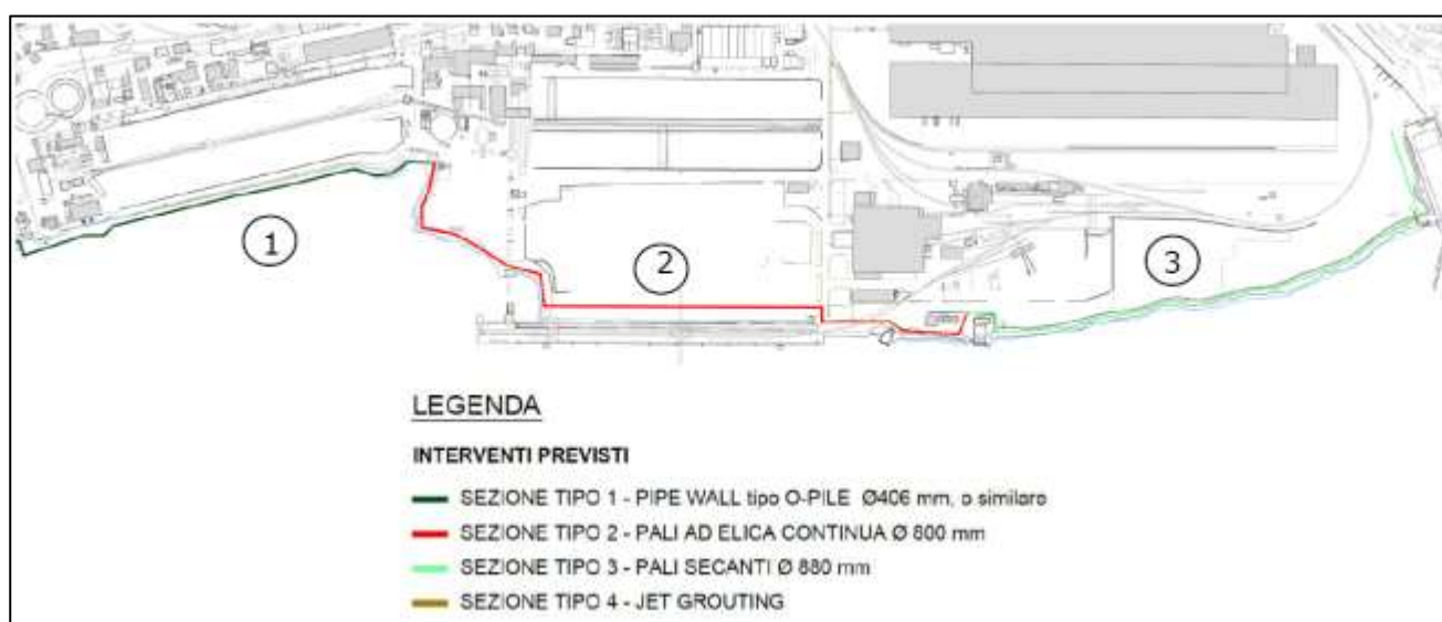
Figura 2-8 Marginamento del progetto INVITALIA con l'ubicazione delle diverse tecnologie
