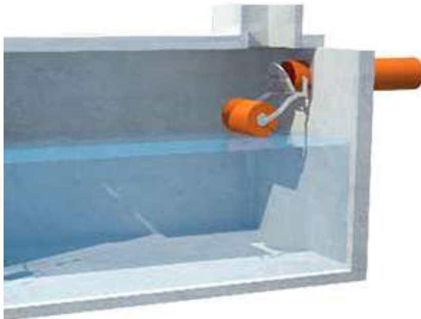
Figura 5-12 Schema di funzionamento della valvola a galleggiante
