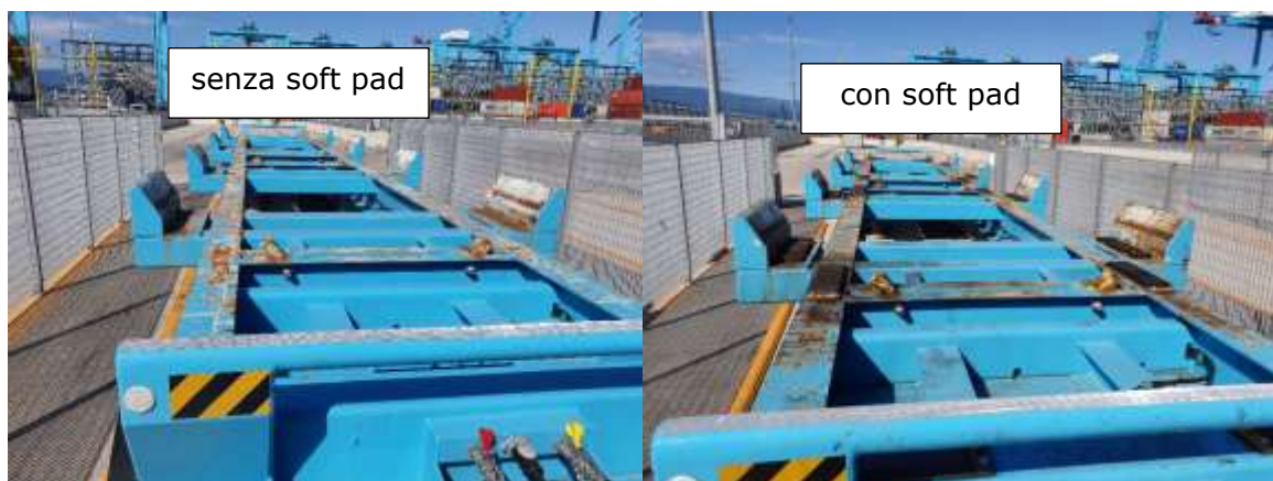
Figura 8-7 - Esempio di soft pad per assorbire il rumore emesso dall'interfaccia tra rimorchio e container
