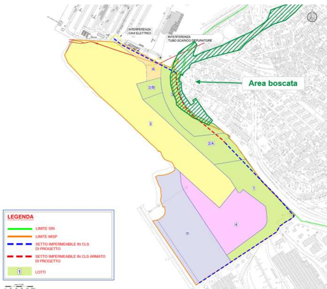
Figura 7-1. Estratto planimetria setto impermeabile con sovrapposizione area boscata.
