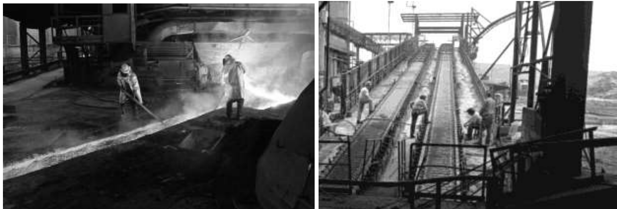
Figura 2-4: versamento della ghisa fusa e nastri trasportatori in manutenzione
