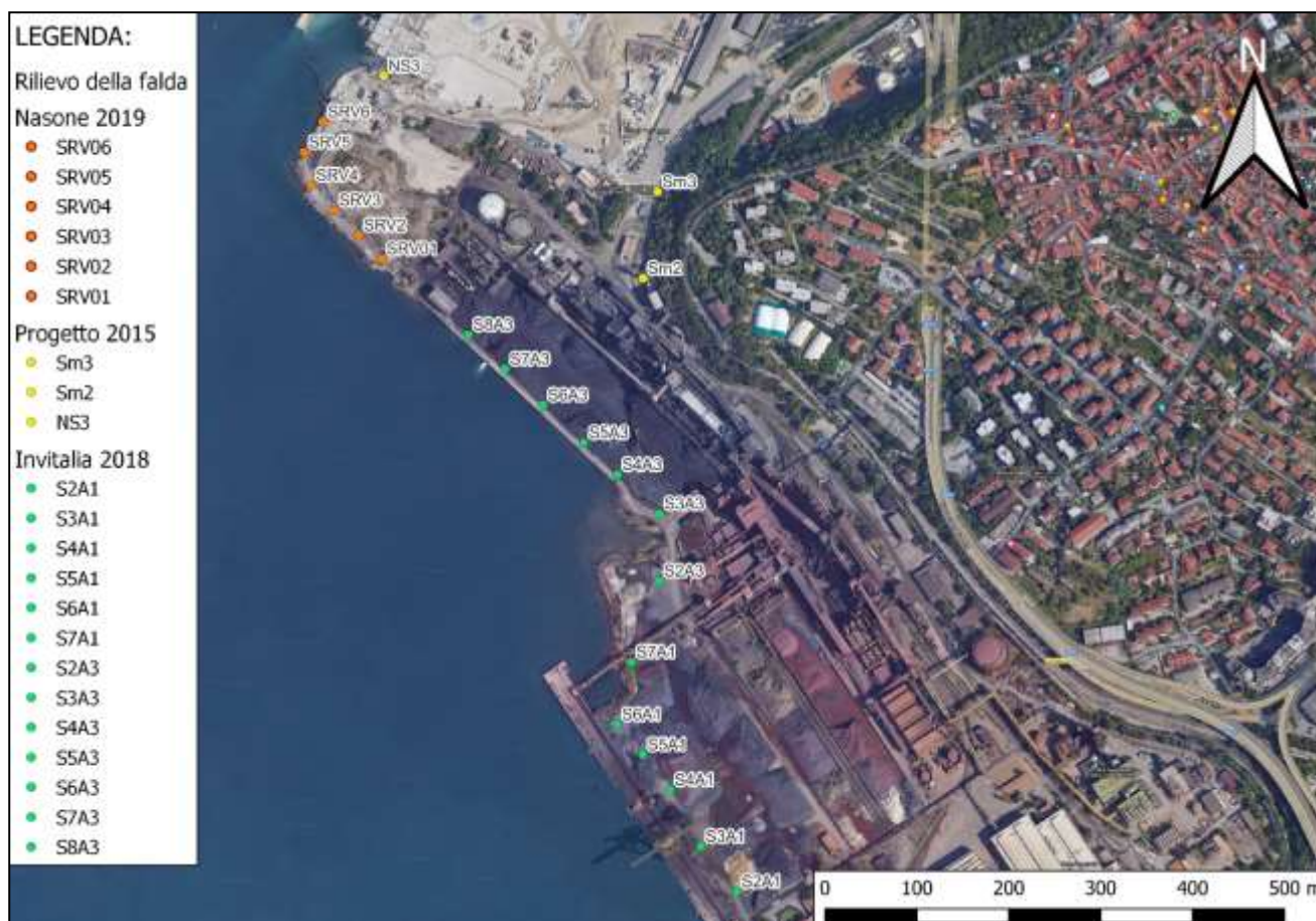
Figura 6-47 - Planimetria dei rilievi di falda eseguiti nella porzione di territorio di interesse (1:5.000)
