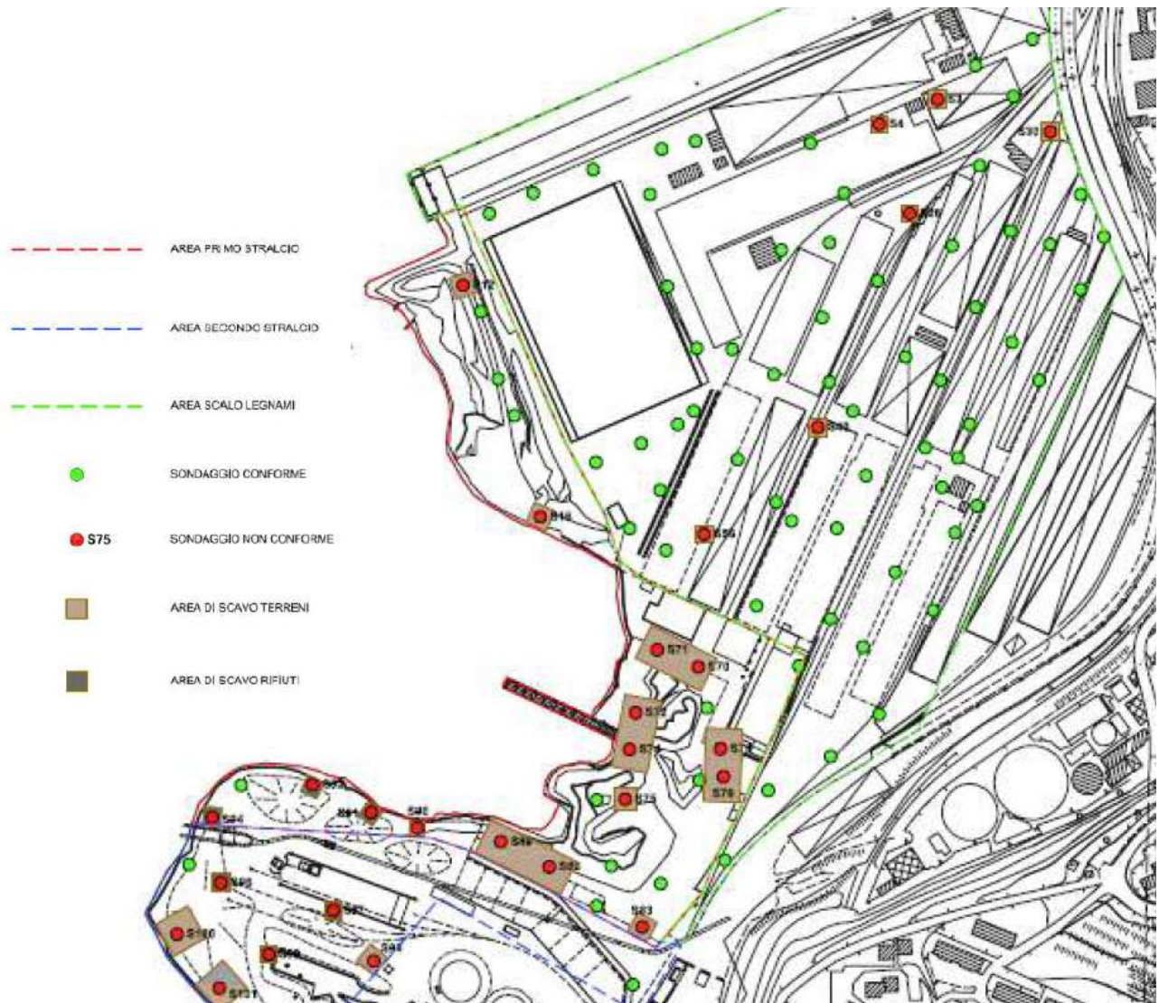
Figura 5-21 caratterizzazione condotta nello scalo legnami e nell'area della piattaforma logistica
