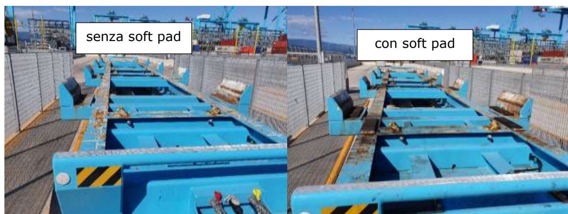
Figura 7-3: Esempio di soft pad per assorbire il rumore emesso dall'interfaccia tra rimorchio e container
