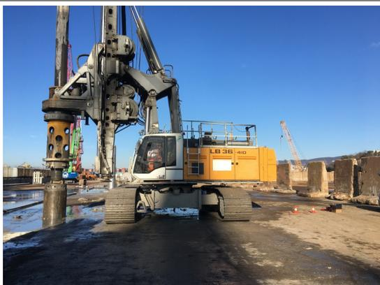
*Figura 21 perforatrice LIEBHERR modello BAT410*
