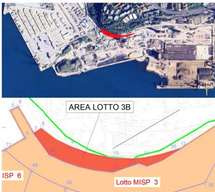
Figura 11 – In rosso l’area del LOTTO 3B corrispondente al piede della collina di Servola, oggetto di scavo e delle opere di messa in sicurezza permanente per la successiva infrastrutturazione
