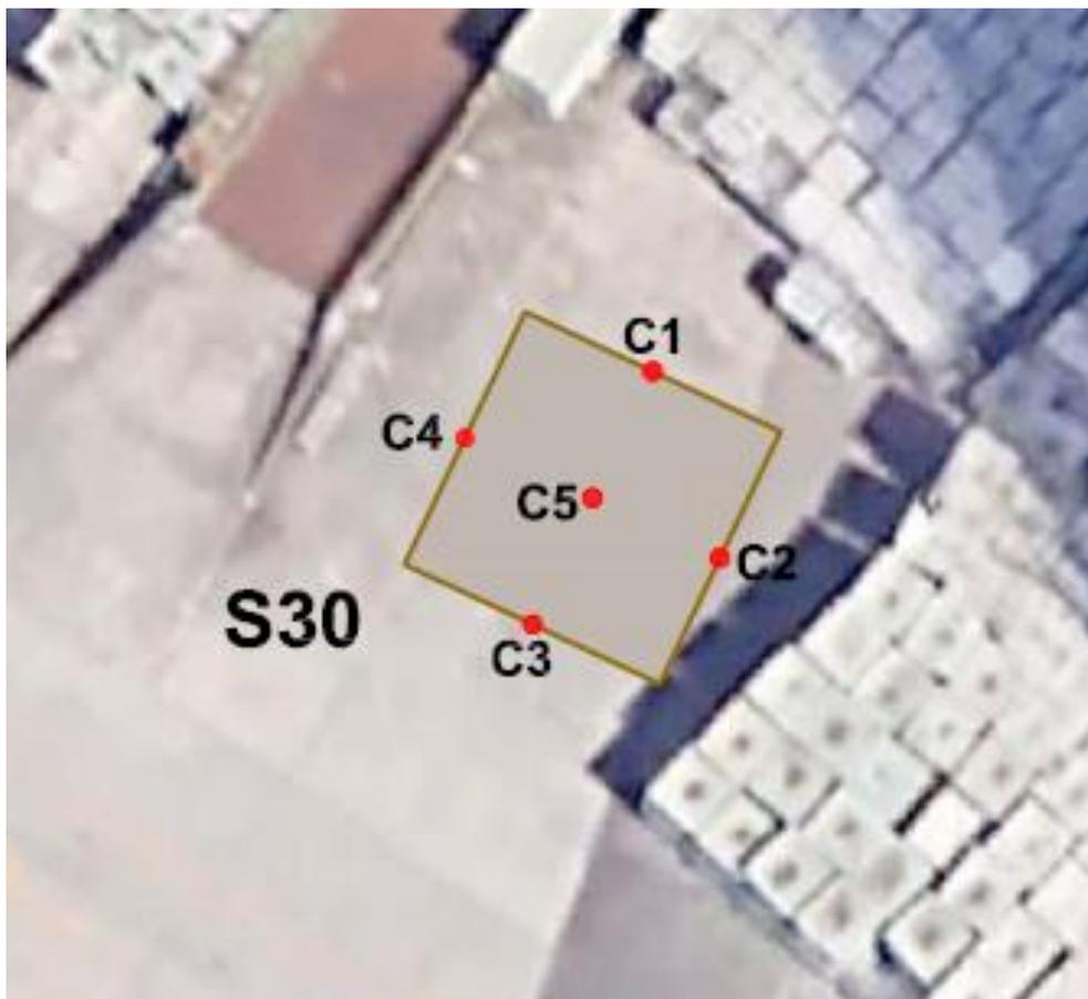
*Figura 11: Punti di campionamento pareti e fondo scavo MISE S30*
