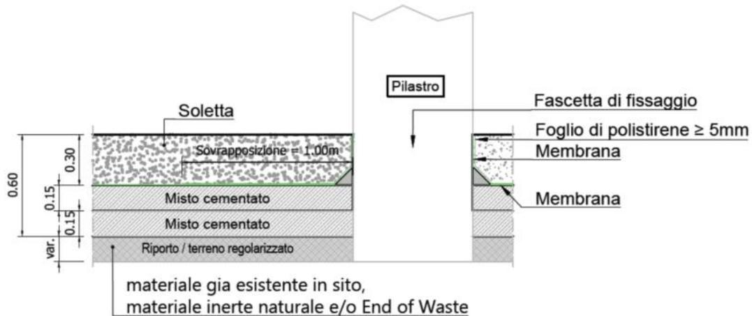
Figura 35: particolare delle sigillature in corrispondenza di una struttura in attraversamento del pavimento di MISP tal quale nella Figura 8.24 della relazione generale del progetto di MISP di Logistica Giuliana e nella figura 5.13 in quella dell'ambito 9MISP del PFTE 1951
