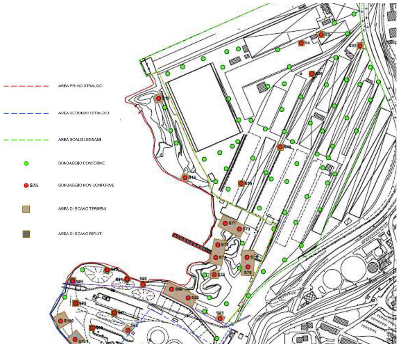
Figura 6-1 caratterizzazione condotta nello scalo legnami e nell'area della piattaforma logistica
