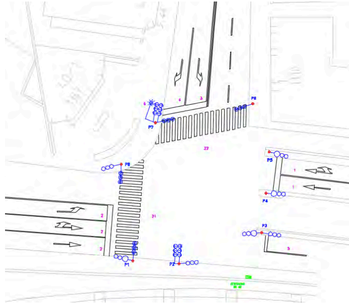
Figura 6 - Layout dell'intersezione K40 con denominazione dei relativi segnali semaforici
