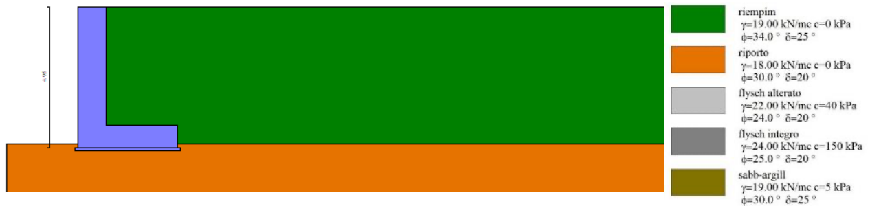
Figura 6-37: schema del muro modellato con Max 15 e applicazione dei carichi.
