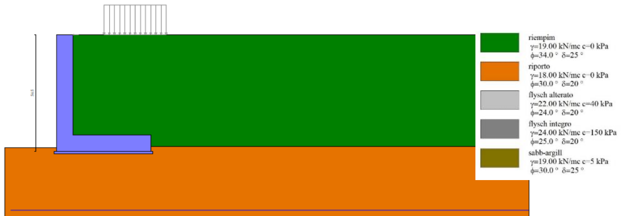
Figura 6-72: schema del muro modellato con Max 15 e applicazione dei carichi.
