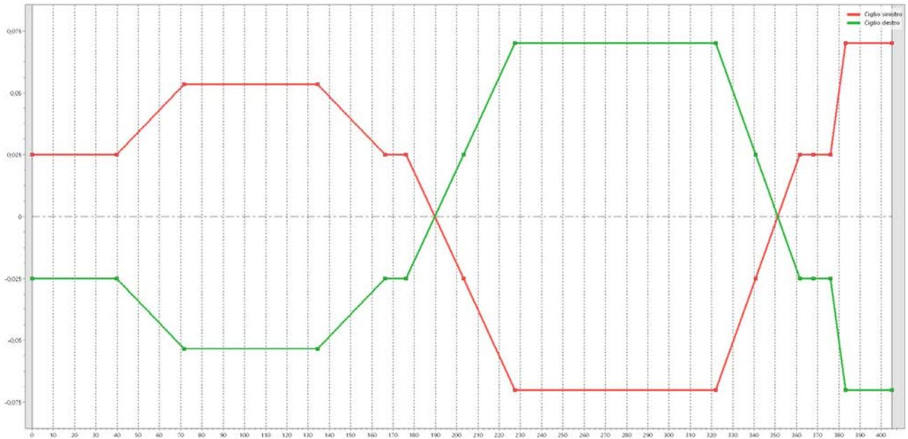
Figura 21: Andamento sopraelevazioni - Rampa semidiretta in uscita sud
