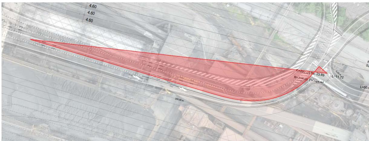
Figura 30: Verifica della distanza di visibilità mediante i triangoli di visibilità.
