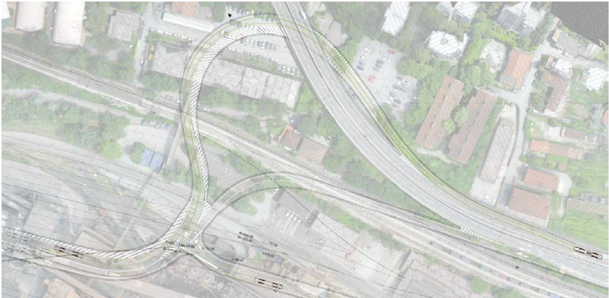
Figura 32: Verifica di inscrivibilità per la rampa in uscita dalla S.S. n. 202.
