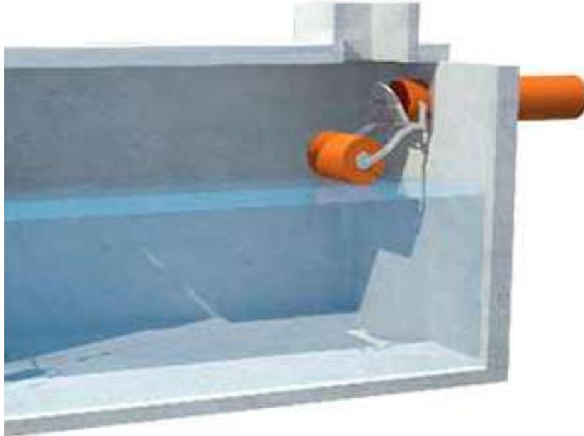
*Figura 5: Schema di funzionamento della valvola a galleggiante*
