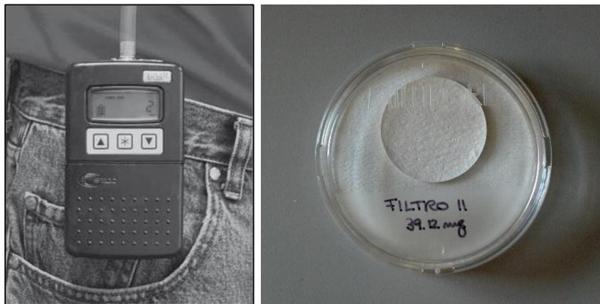
Figura 4.4 Autocampionatore Air Check e filtri GF/F
