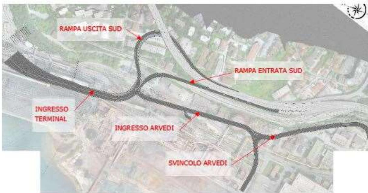
Figura 1 - progetto dello svincolo con soluzione a 2 rampe
