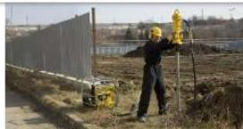
...attivabile direttamente sull'utensile. La versione T è eccellente per tubi di guardrail, profili, segnaletica e una vasta gamma di ancoraggi e pali.
