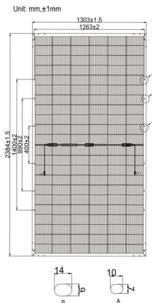
Dettagli del pannello fotovoltaico
